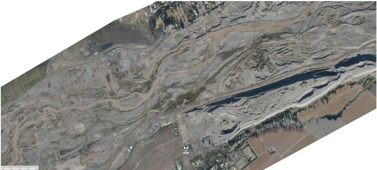
**Figura 7-1: Efectos de la actividad de extracción de áridos sobre el lecho del Maipo.**
