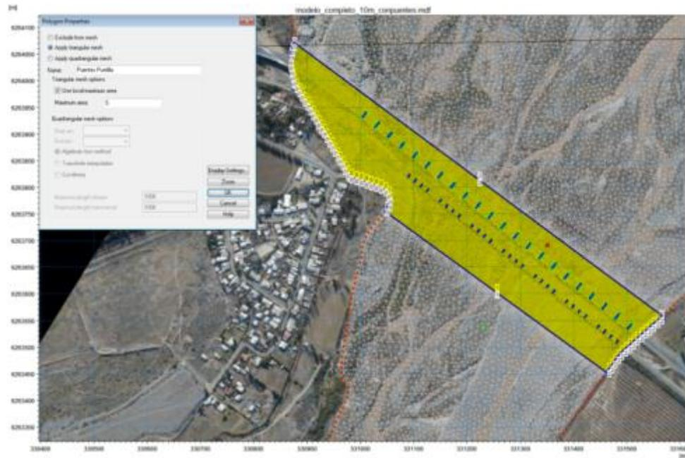
Figura 6-3: Malla en zona de pilares, Puentes Puntilla.
